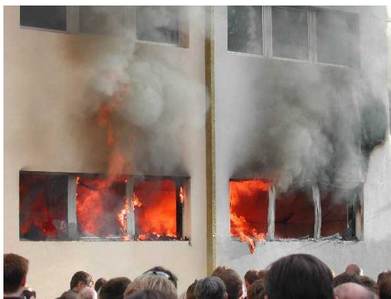
Foto: Fassadenbrandtest (27. Prüfminute)
