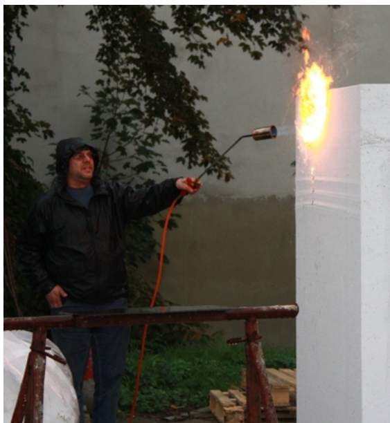
Foto: Block aus Baustyropor durch Flämmer beansprucht
