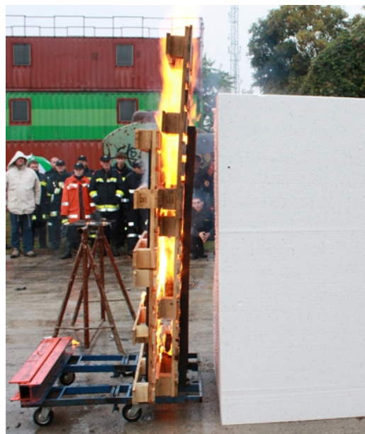
Foto: Brennende Holzpaletten vor Block aus Baustyropor
